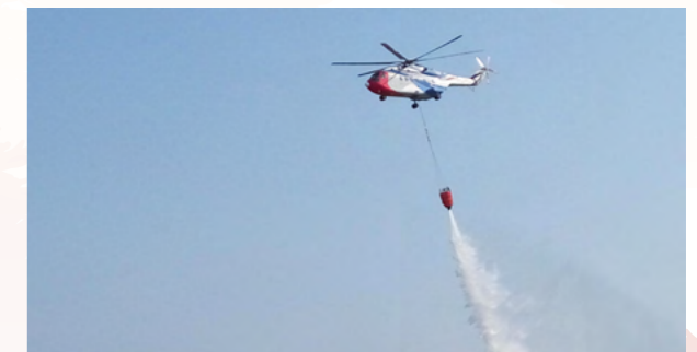
进行吊桶灭火操作
